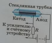
Рис. 159. Схема устройства счётчика Гейгера
