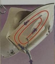
**КОРОТКОЕ ЗАМКЫКАНИЕ** Провода, соединяющие потребителя тока с источниками электрической энергии, например квартирная проводка, всегда рассчитаны на определенную максимальный ток. Но разным причинам сила тока может превышать допустимое значение, что приведет к перегреву проводов и воспламенению их изоляции.
